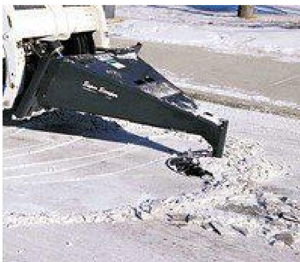
Рисунок 17. Скалывающее оборудование снегоочистителя КО-707.
