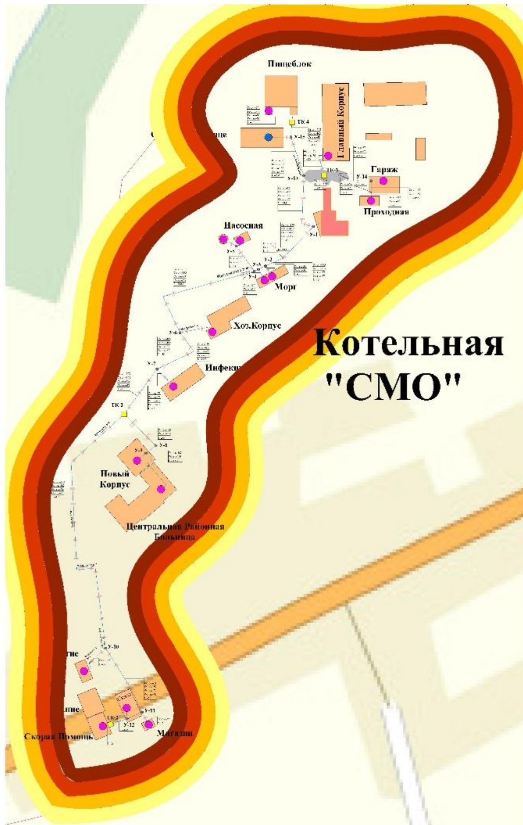
Рис. 2.4. Зона действия котельной «СМО»
